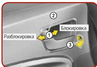
Управление замками дверей изнутри автомобиля
