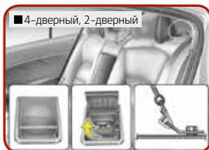
Закрепление детского автокресла с помощью системы якорных ремней. См. руководство по эксплуатации [3].
