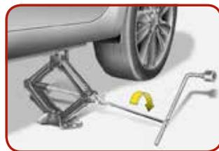
9. Ослабьте гайки колеса и снимите их пальцами. Снимите колесо со шпилек и положите его плашмя на землю, чтобы оно не укатилось. Чтобы установить на ступицу запасное колесо, совместите отверстия в диске со шпильками и посадите на них колесо. Если вам не удастся этого сделать, немного наклоните колесо и совместите верхнее отверстие в диске с верхней шпилькой. Покачивая колесо вперед-назад, посадите его на остальные шпильки.
