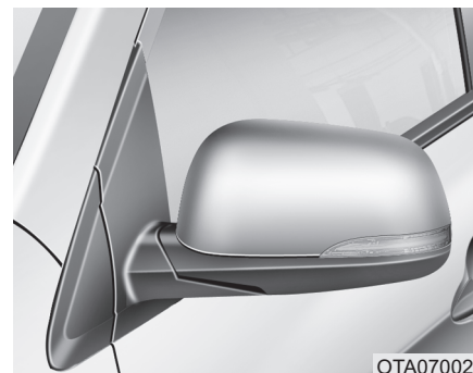
Замена лампы бокового повторителя указателя поворота
