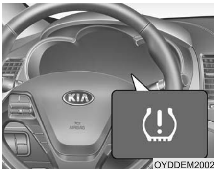
Сигнализатор низкого давления в шинах / Индикатор неисправности системы TPMS
