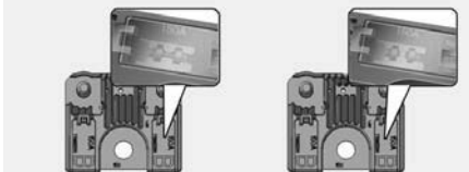
Исправный предохранитель Сгоревший предохранитель
